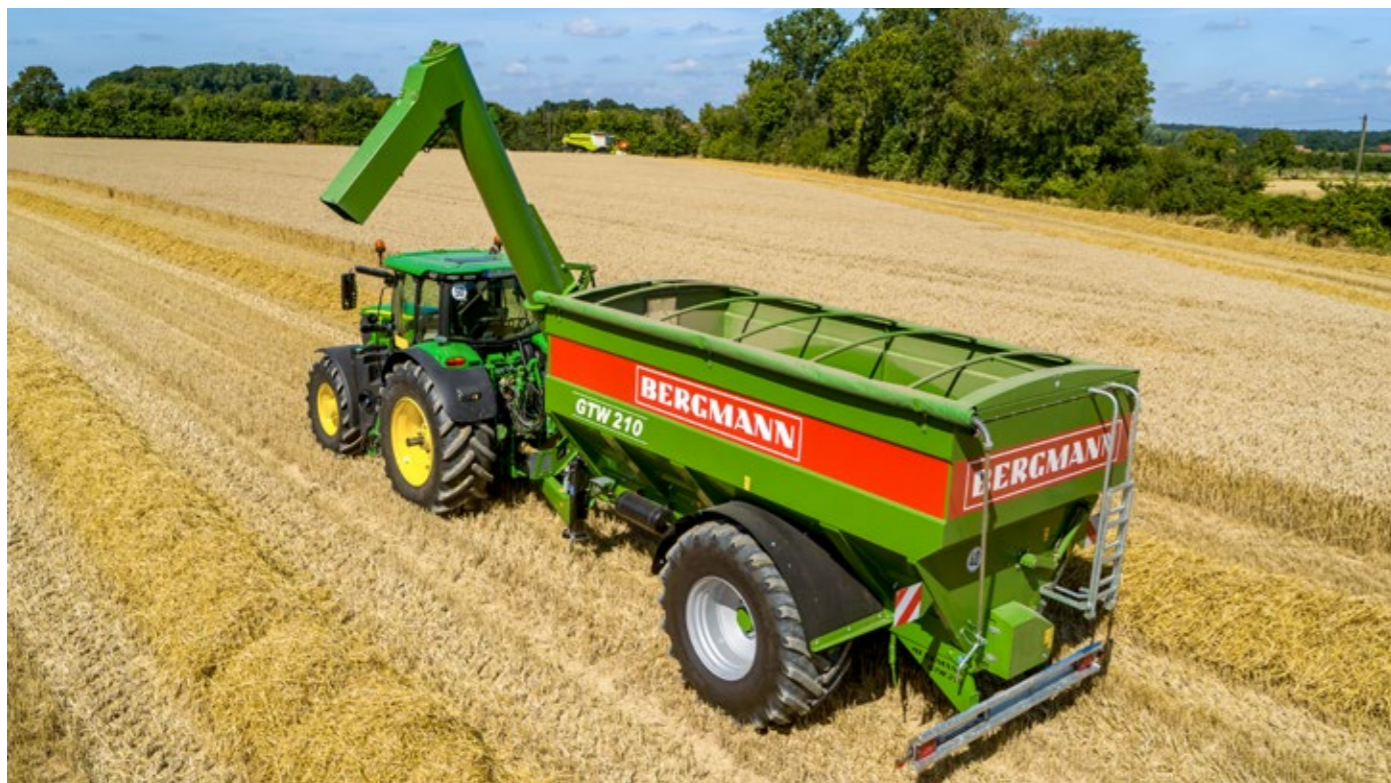
GTW 210 GTW 210 o pojemności ładunkowej 21 m 3 stanowi przejście do przyczep przeładowczych BERGMANN. Moc załadunkowa wynosi ok. 400 t/h.
