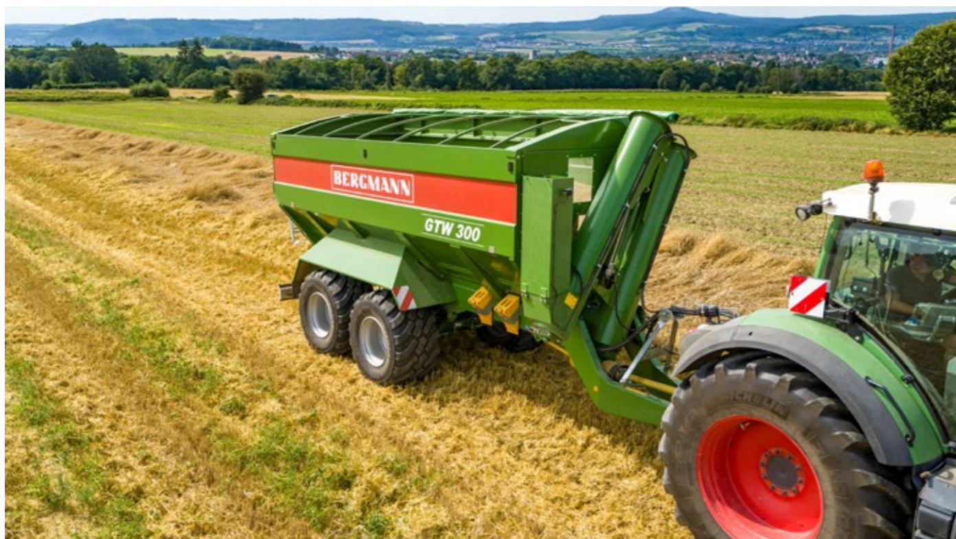
GTW 300 Model GTW 300 o pojemności ładunkowej do 30 m 3 jest wyposażony w solidny zespół wahadłowy z zawieszeniem parabolicznym. Moc załadunkowa wynosi ok. 400 t/h.
