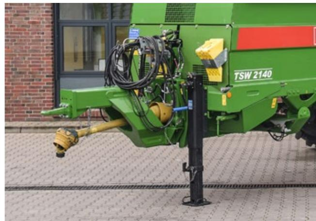
Pour l'attelage, il est possible de choisir entre différents anneaux d'attelage. Disponible de série, l'attelage à boule offre un confort de conduite maximal avec une usure minimale. Les flexibles hydrauliques sont bien fixés dans le support prévu à cet effet et donc bien protégés de la saleté.
