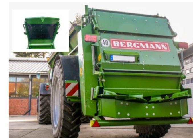
de distribution du produit d'épandage sur les disques d'épandage. Différents produits d'épandage peuvent ainsi être épandus avec précision dans différentes conditions. Une sécurité à ressort sert de protection contre les corps étrangers.
