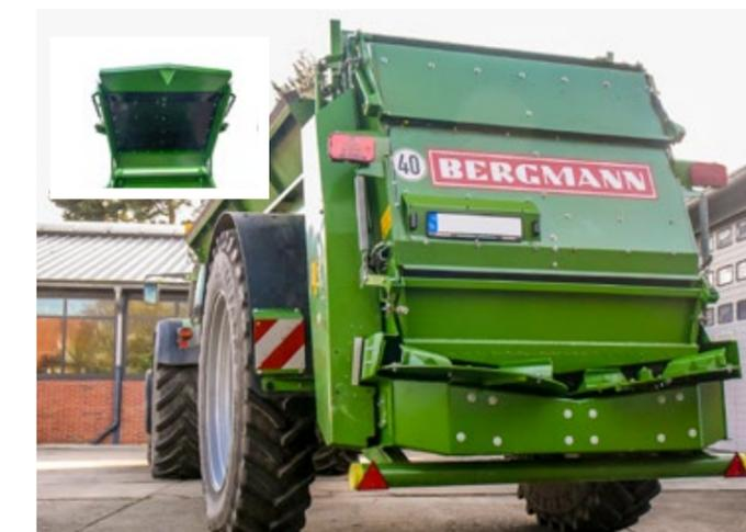
Streuguts auf die Streuteller. So können verschiedene Streugüter unter unterschiedlichen Bedingungen präzise ausgebracht werden. Eine Federsicherung dient als Schutz bei Fremdkörpern.
