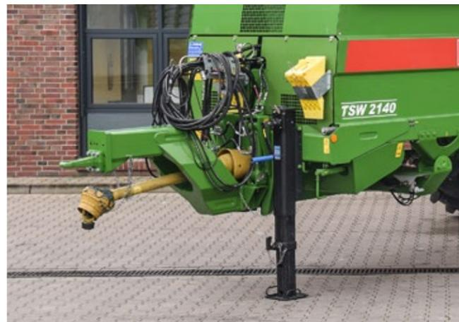
Bei der Anhängung kann zwischen verschiedenen Zugösen gewählt werden. Die serienmäßige Zugkugelumfassung bietet höchsten Fahrkomfort bei geringstem Verschleiß. Die Hydraulikschläuche werden sauber in die Schlauchgarderobe eingehängt und sind so vor Verschmutzung geschützt.
