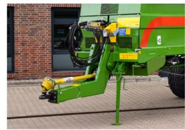
Bei der Anhängung kann zwischen verschiedenen Zugösen gewählt werden. Die optionale Zugkugelkupplung bietet höchsten Fahrkomfort bei geringstem Verschleiß. Die Hydraulikschläuche werden sauber in die Schlauchgarderobe eingehängt und sind so vor Verschmutzung geschützt.
