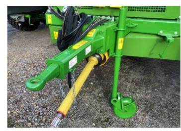
Als Zugöse ist immer die Norm-Zugöse mit 40 mm Durchmesser verbaut. Die Hydraulikschläuche werden sauber in die Schlauchgarderobe eingehängt und sind so vor Verschmutzung geschützt.
