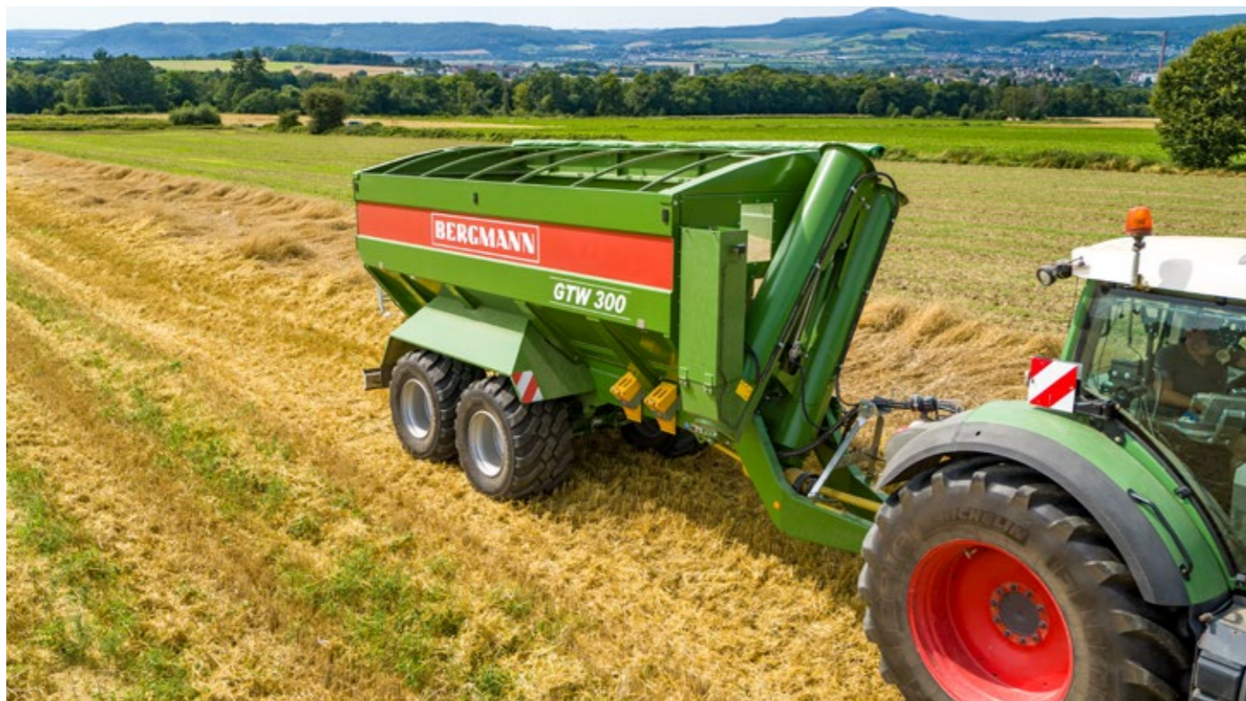
GTW 300 Der GTW 300 mit bis zu 30 m 3 Ladevolumen ist mit einem robusten parabelgefederten Pendelaggregat ausgestattet. Die Überladeleistung beträgt ca. 400 t/h.
