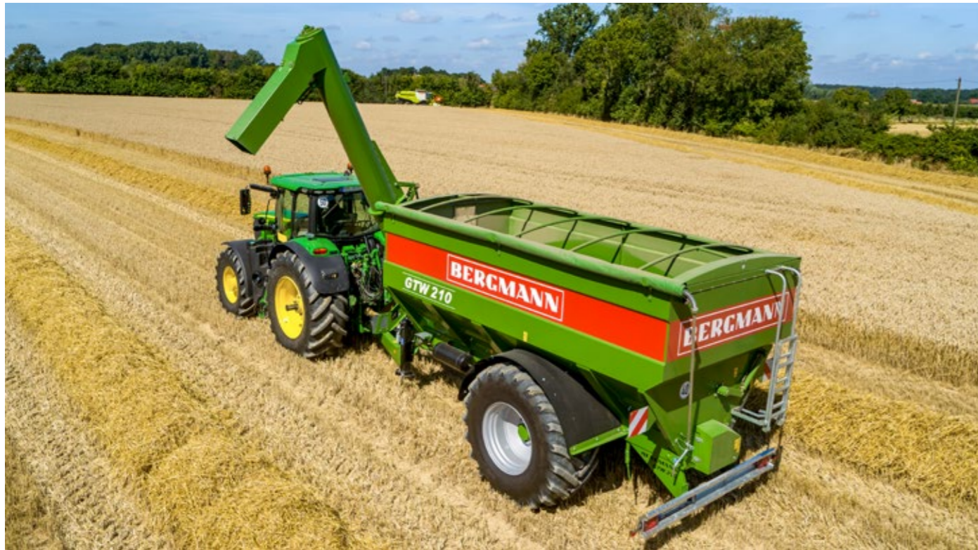
GTW 210 Mit 21 m 3 Ladevolumen macht der GTW 210 den Einstieg in die BERGMANN Überladewagen. Die Überladeleistung beträgt ca. 400 t/h.
