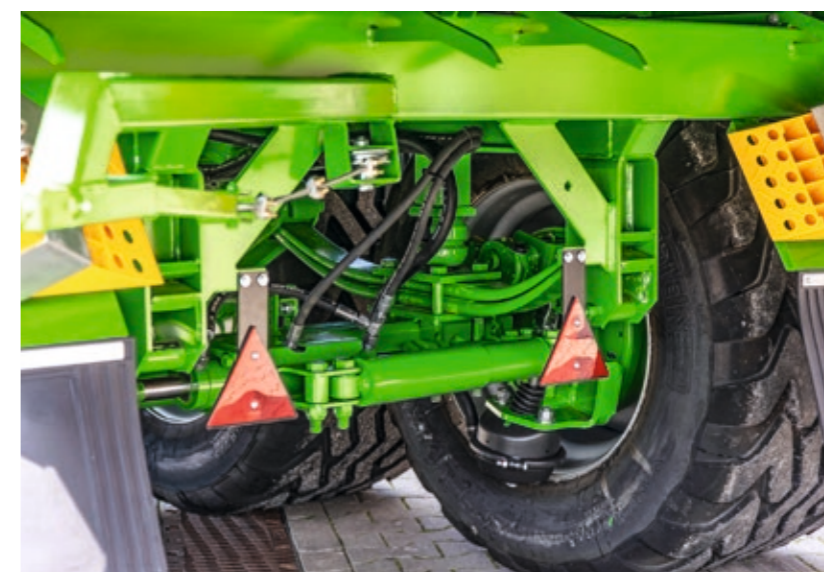
Oś skrętna wleczona dostępna jako wyposażenie opcjonalne zapewnia większy komfort jazdy, znacznie mniejsze zużycie opon i lepszą ochronę podłoża.
