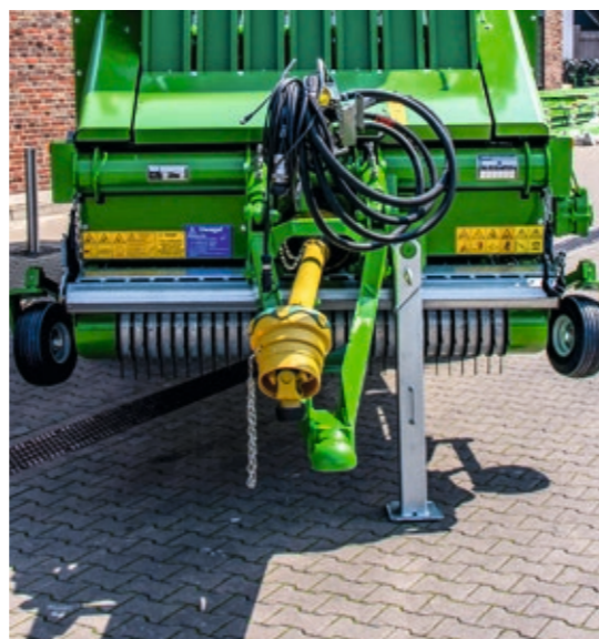
Kompaktowa konstrukcja wąskiego dyszla zapewnia dużą zwrotność. Stopa podporowa jest wykonana w wersji wychylnej i mocuje się ją do ramy.
