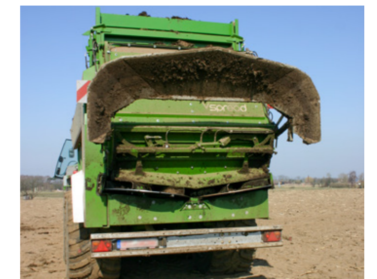
Adapter rozrzucający V-Spread o średnicy talerzy rozrzucających 1.100 mm z sześcioma łopatkami rozrzucającymi.
