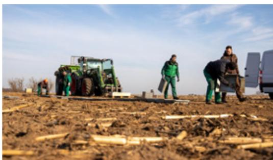
◀ *Установка тестовых лотков для определения качества поперечного распределения.*
