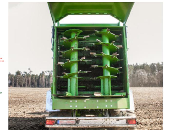
Разбрасывающее устройство 2-Spread с двумя вертикально расположенными разбрасывающими барабанами
