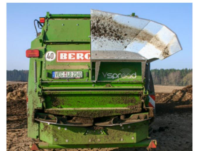
Разбрасывающее устройство V-Spread с разбрасывающими дисками диаметром 1.000 мм, укомплектованными четырьмя разбрасывающими лопатками.
