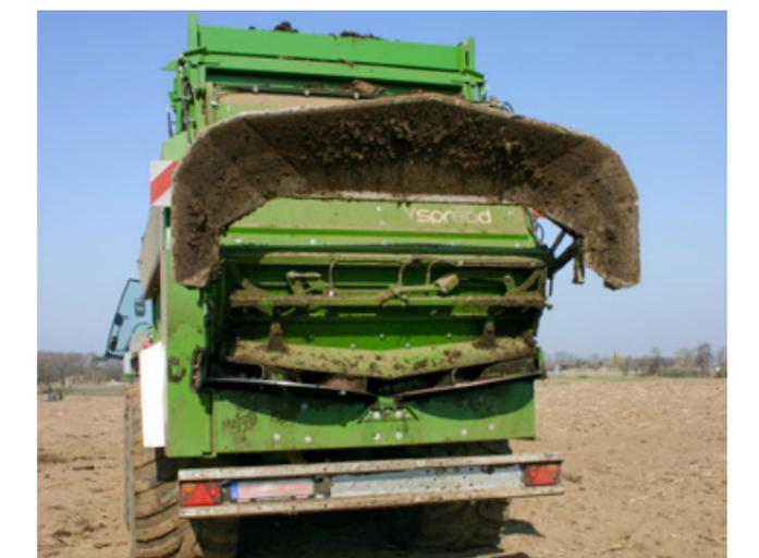
Разбрасывающее устройство V-Spread с разбрасывающими дисками диаметром 1.100 мм, укомплектованными шестью разбрасывающими лопатками.
