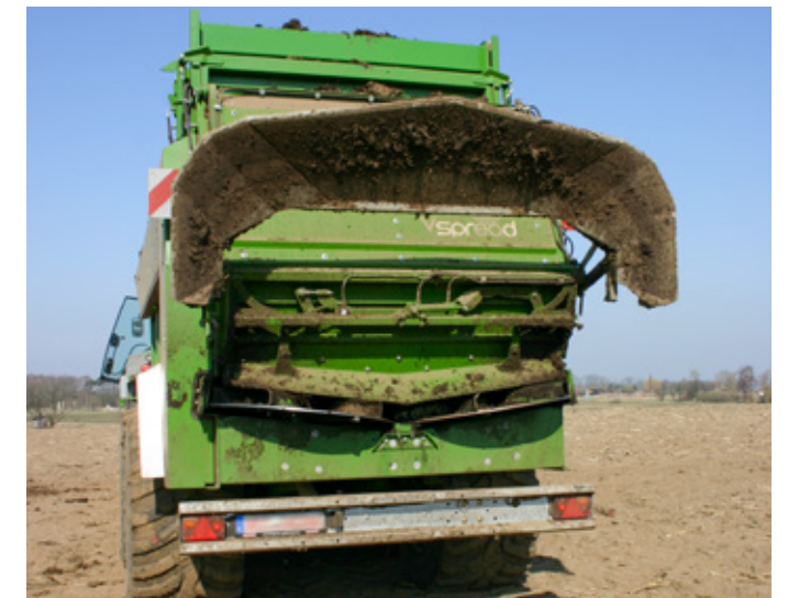
Le dispositif d'épandage V-Spread avec des disques d'épandage de 1.100 mm de diamètre et six ailettes d'épandage.
