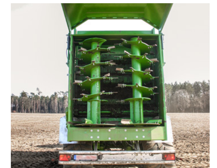
Le dispositif d'épandage 2-Spread avec deux hérissons verticaux
