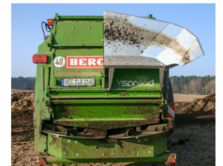
Le dispositif d'épandage V-Spread avec des disques d'épandage de 1.000 mm de diamètre et quatre ailettes d'épandage.
