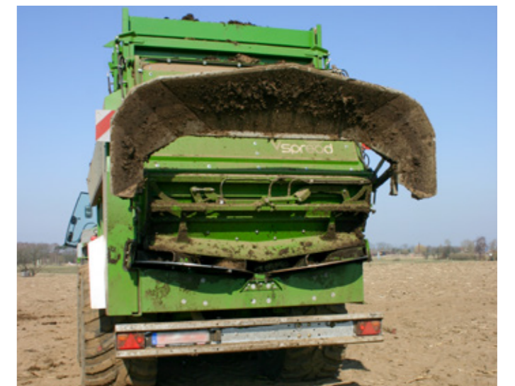
Das V-Spread Streuwerk mit 1.100 mm Durchmesser der Streuteller und sechs Streuflügeln.
