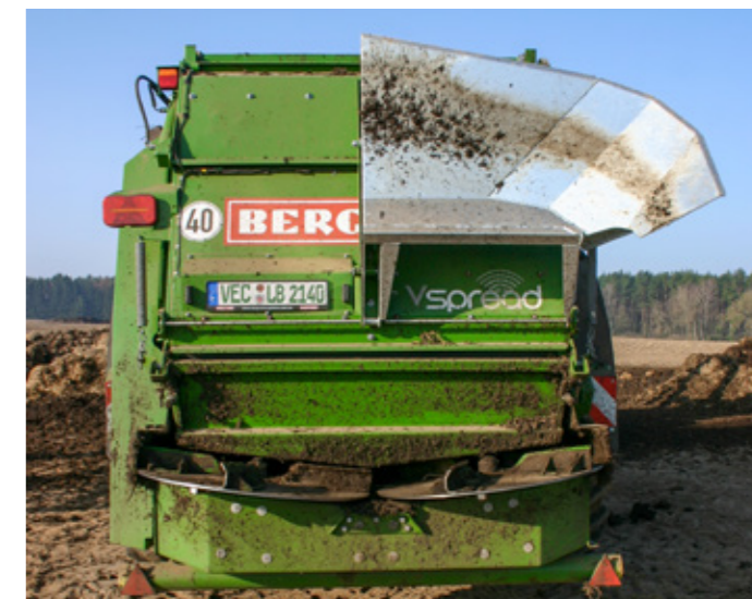
Das V-Spread Streuwerk mit 1.000 mm Durchmesser der Streuteller und vier Streuflügeln.
