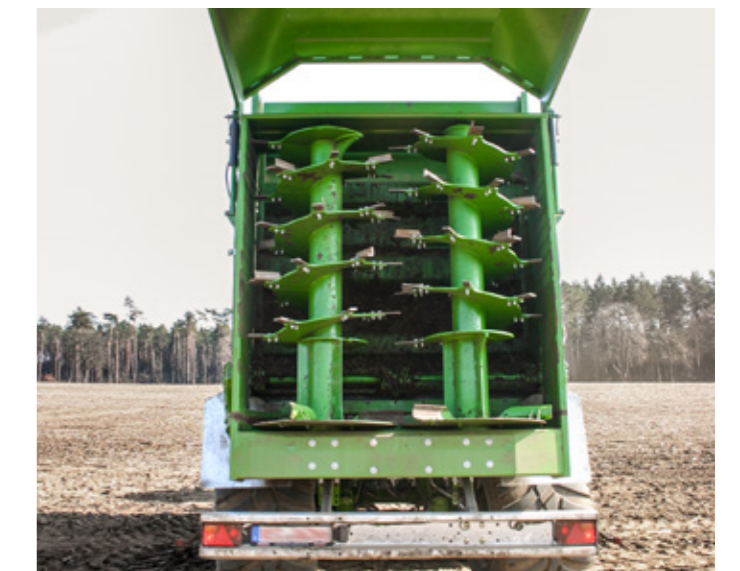
Das 2-Spread Streuwerk mit zwei stehenden Walzen.
