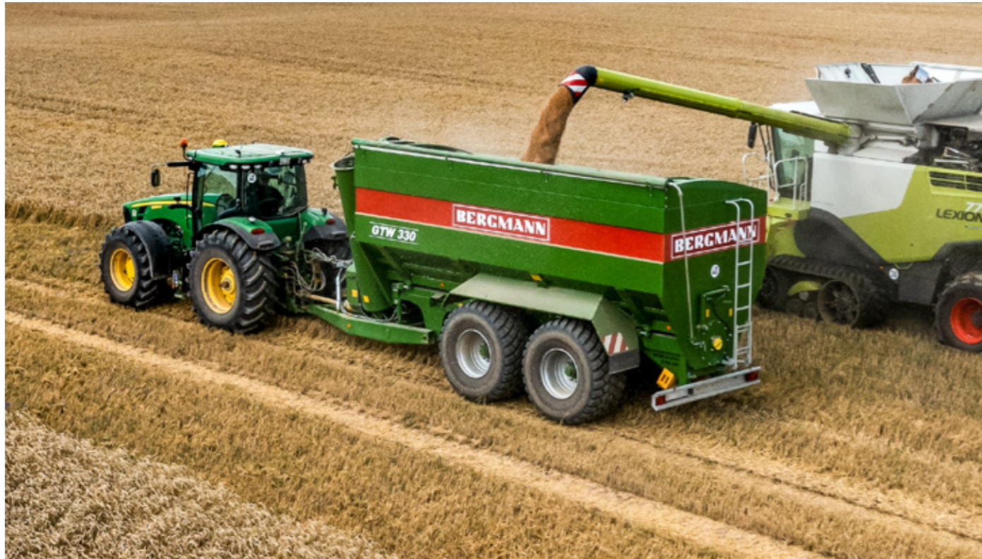
GTW 330 S ložným objemem 33 m 3 se GTW 330 řadí do vyšší třídy překládacích vozů BERGMANN. Překládací výkon je přibližně 1 100 t/h.
