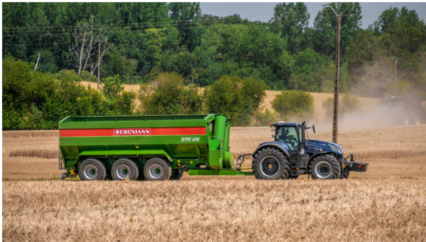
GTW 430 Model GTW 430 s ložným objemem 43 m 3 je vlajkovou lodí překládacích vozů BERGMANN. Překládací výkon je přibližně 1 100 t/h.
