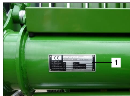
Photo 4 : Emplacement de la plaque signalétique
