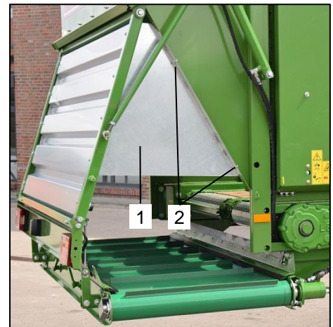
Photo 47 : Démontez les tôles de protection
