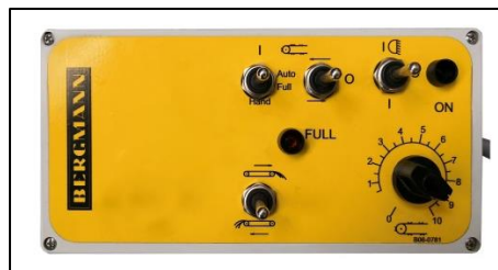
Photo 103 : Terminal Pilotbox convoyeur transversal
