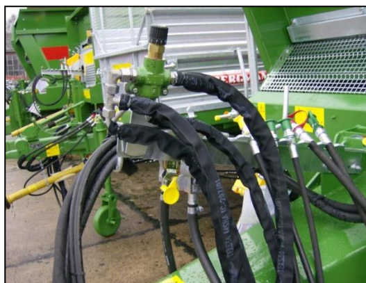
Imagine: stabilizator de curent pe brațul hidraulic
