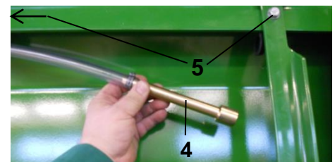
Ilustracja: Wymowanie rurki spustowej
