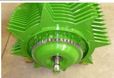
B02-1213 Ilość napełnienia 3,2 l Olej dla przekładni: ISO VG 460 olej syntetyczny
