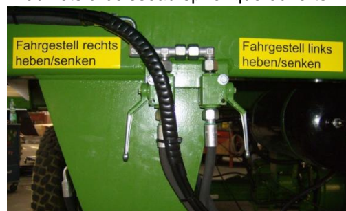
Photo : Robinets à boisseau sphérique ouverts
