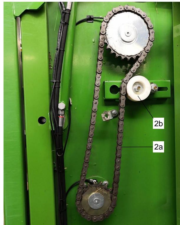
Photo 62 : Entraînement de l'unité de dosage à droite
