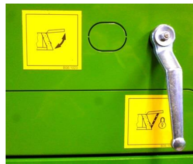
Photo : Vanne d'arrêt de la porte arrière
