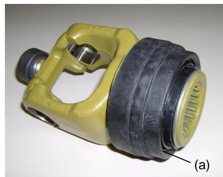
Photo : Verrouillage rapide à billes
