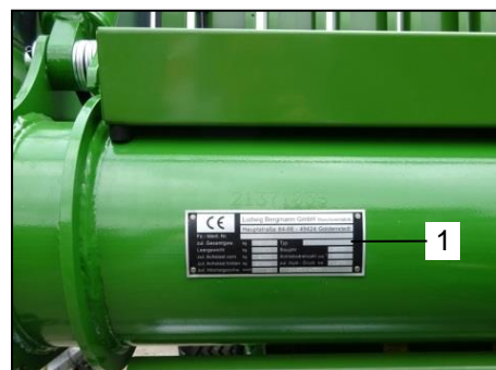
Photo 3 : Emplacement de la plaque signalétique
