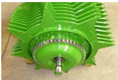
B02-1213 Quantité de remplissage 3,2 litres Huile à engrenages : huile synthétique ISO VG 460
