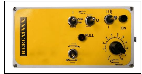
Ilustr. 103: Terminal pilotbox przenieśnik poprzeczny
