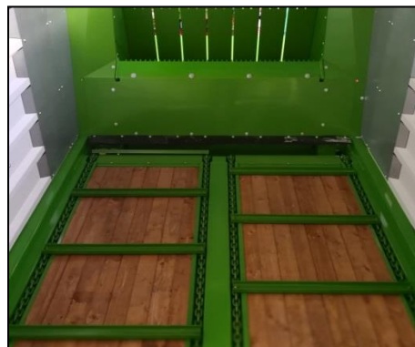
Ilustr. 33: Łańcuchy podłogi transportującej
