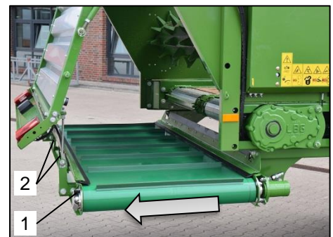
Ilustr. 43: Wyciąganie przenośnika poprzecznego
