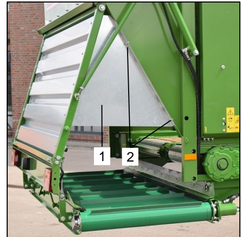
Ilustr. 47: Zdemontować blachę osłaniającą
