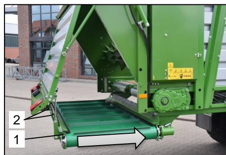
Ilustr. 50: Wsunąć przenośnik poprzeczny.
