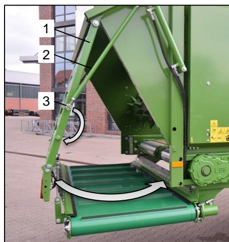
Ilustr. 51: Przebudować klapę tylną
