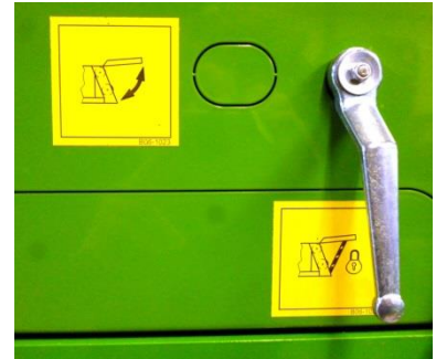
Kuva: Takalaidan sulkuventtiili
