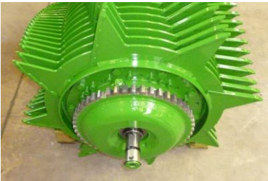
B02-1213 Täyttömäärä 3,2 litraa Vaihteistoöljy: ISO VG 460 synteettinen öljy
