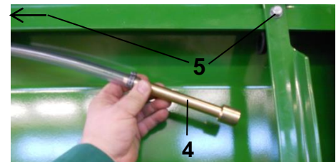
Kuva: Liitosputken irrottaminen
