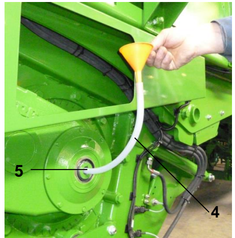
Kuva: Vaihteistoöljyn täyttäminen
