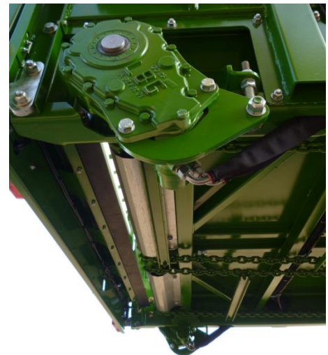
Kuva: Pohjakuljettimen käyttökoneisto
