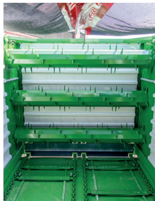
Rouleaux démêleurs de la Version S avec, de série, trois rouleaux (SHUTTLE 450 S / SHUTTLE 490 S).
