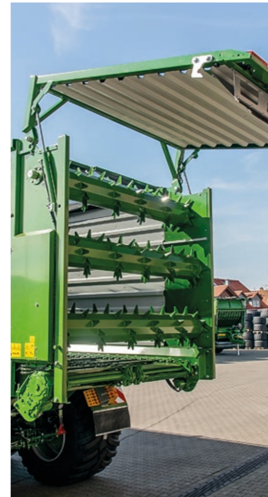
Direkter Antrieb der unteren Dosierwalze über Winkelgetriebe, Antriebswellenlagerung an der Fahrzeugseitenwand.
