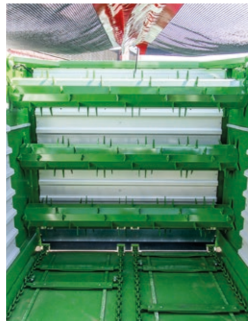
Dosieraggregat der S-Modelle mit serienmäßig drei Dosierwalzen (CAREX 370 S / CAREX 410 S).
